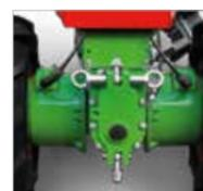
Schnellkupplungssystem erleichtert das Wechseln der Anbaugeräte
