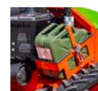
Agria-Wechseltanksystem, Füllstandsanzeige auf Fernbedienung
