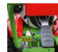
Fahrtrichtungswechsel vorwärts/rückwärts einfach per Fußhebel schaltbar
