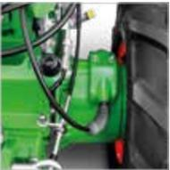
Robuste Lenkbremsekupplungen für einfaches Lenken
