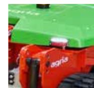
LED-Signalleuchten zur Anzeige der Fahrtrichtung
