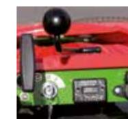
Praktische Armaturentafel mit Betriebsstundenzähler, Drehzahlmesser, Zündschloss und 12 V-Steckdose
