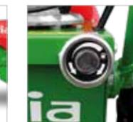
Stufenloses Einstellen der Bürstendrehzahl
