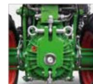
Agria-Anbauflansch: einfacher und schneller Anbaugerätewechsel
