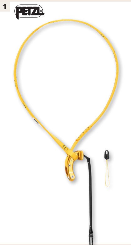
1 Petzl Kambiumschoner Naja EN 795 B. EN 12278. Bruchlast 25 kN.
